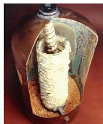
L'entartrage ou la corrosion engendrent des désagréments (radiateurs froids, bruits de chaudière, fuites ...).
